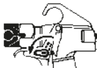
Bloqueio de gatilho na posição travada.
