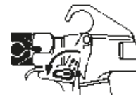
Bloqueio de gatilho na posição travada.
