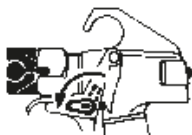
Bloqueio de gatilho na posição travada.
