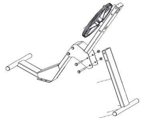
**3** - Colocar o tambor no chassi central para que a coroa da cremalheira encaixe nos 03 parafusos 3/8" x 3" com 03 arruelas lisas 3/8" (9,9x27x4,0) na parte inferior do tambor. De frente para o tambor, dentro dele, colocar as 03 arruelas lisas sobre os parafusos. Apertar as porcas.
