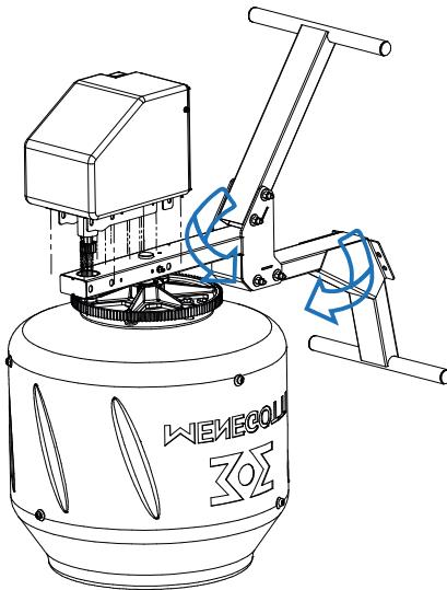
**5** - Fixar o guidão no chassi com 02 parafusos  $3/8'' \times 4.1/2''$  + 02 arruelas e 02 porcas  $3/8''$ . Montar as duas partes da proteção da cremalheira fixando 02 parafusos autobrocantes no chassi central e fixando 02 parafusos M6x16 com 02 porcas autotrvavantes M6 nas extremidades superior e inferior da proteção. Fixe também o suporte da caixa do motor, use 03 parafusos  $3/8'' \times 4.1/2''$ , 03 porcas e 06 arruelas planas.
