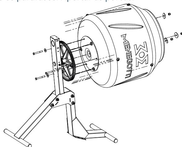
**4** - Colocar o tambor com a boca para baixo, no chão. Encaixar a caixa do motor no chassi. Verificar a cremalheira e o acoplamento do pinhão. Se não houver acoplamento, girar o chassi até engatar a cremalheira no pinhão.
