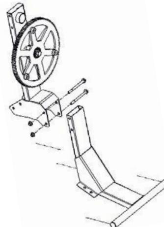
**2** - Montar o chassi traseiro usando 04 arruelas, 02 porcas e 02 parafusos 3/8" x 4.1/2" fornecidos junto com o equipamento.
