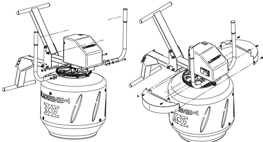
**6** - Montar o eixo no chassi com gancho "U", com arruelas planas e porcas  $3/8''$ , usando as marcas para auxiliar no processo de centralização. Fixar a roda na extremidade do eixo com 02 arruelas planas  $28x45x2,7$  e 02 contrapinos no eixo.
