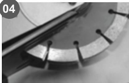
04. Alinhe os discos de uma forma em que todos os vincos (recortes redondos) fiquem centralizados. Isso é importante para que ocorra o resfriamento das lâminas e a saída da poeira durante o corte.
